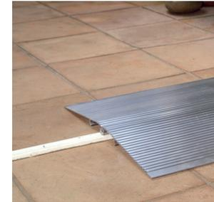
**Typ SBA** Die zweiteilige Schwellenbrücke SBA ist bei unterschiedlichen hohen Türschwellen einsetzbar. Sie ist sehr leicht und handlich. Die SBA ist keine selbsttragende Brücke, d.h. der Drehpunkt in der Mitte muss immer auf der Schwelle aufliegen.
