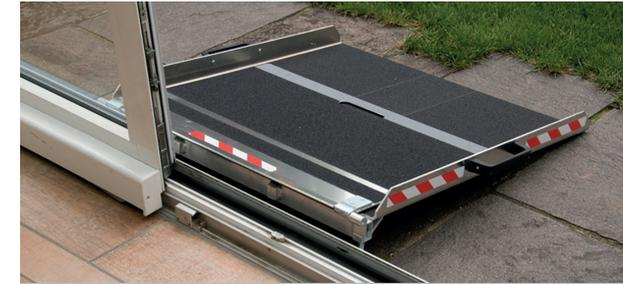
**Typ BTR** Mit der BTR-Rampe sind Balkon oder Terrasse keine unerreichbaren Zonen mehr. Höhenverstellbare Spindelfüße ermöglichen den Einsatz an fast jeder Türschwelle. Durch ein Scharnier kann die Rampe platzsparend zusammengelegt werden und verbleibt bei Nichtgebrauch auf Balkon oder Terrasse. Beim nächsten Einsatz wird sie einfach wieder auseinander geklappt und ist sofort benutzbar.
