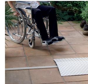
**Typ SBS** Mit der Schwellenbrücke SBS sind Türschwellen oder Erhöhungen für Rollstuhlfahrer leicht zu überbrücken. Es können Schwellen bis zu einer Höhe von 35 mm und eine Breite von 120 mm ohne Mühe überfahren werden.
