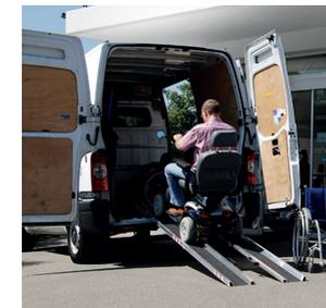
**Typ RAS** Die Aluminium-Auffahrhilfen sind aus einer hochfesten Aluminium-Legierung hergestellt. Die Fahrfläche ist mit einem rutschsicheren Korundbelag beschichtet.
