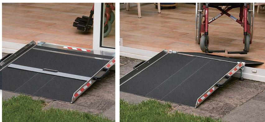
Bei dieser Rampenlösung bleibt die wetterfeste Außenrampe auch an der Terrassen- oder Balkonschwelle angelegt draußen. Die hier ebenfalls wetterfeste Innenrampe wird bei Nichtgebrauch nach außen weggeklappt. Bei dieser Lösung wird allerdings eine Hilfsperson benötigt, die die Rampe umklappt.
