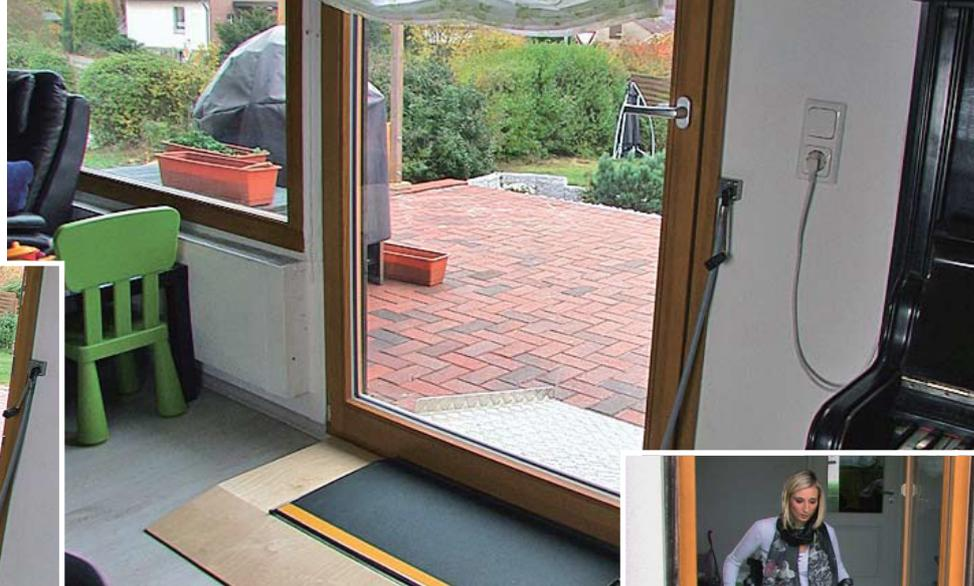
Mithilfe von Rampen, hier eine Türschwellenbühne mit Kurbeltechnik, können Türschwellen zur Terrasse oder zum Balkon von einer Rollstuhlfahrerin/einem Rollstuhlfahrer ohne fremde Hilfe überwunden werden.
